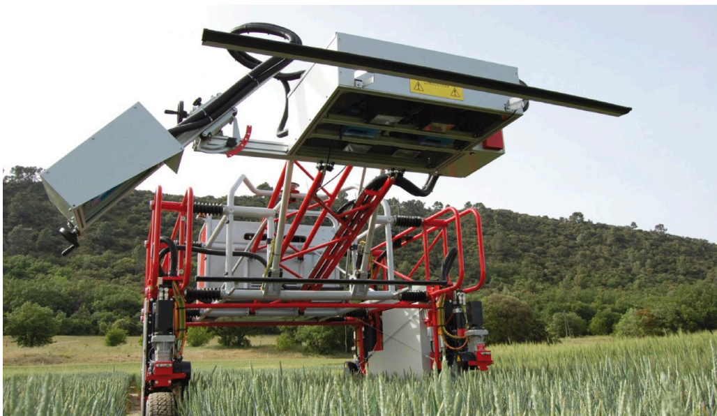
PhénoMobile, un robot autonome qui scanne la végétation des parcelles agricoles
